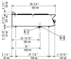
Electrical inlet (power) FΩ **Equipotential screw**
